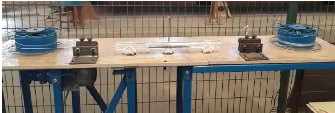
Şekil 4. Tel açma ve tel sarma makaraları ve telin plazma reaktörü içine girişi ve dışına çıkışındaki yönlendirme makaraları
