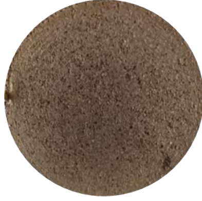
Şekil 8. 600 °C de sinterlenen numunenin makro görüntüsü
