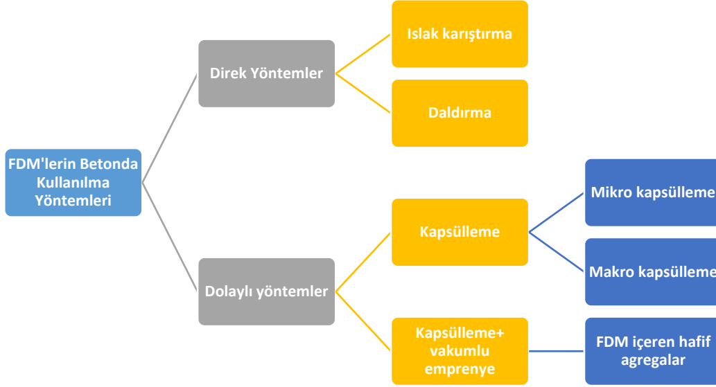
Şekil 3. FDM'lerin betonda kullanma yöntemleri
