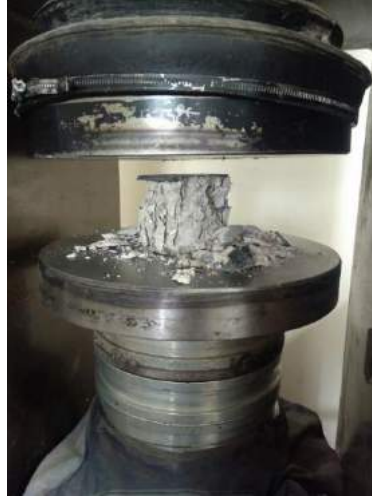
Şekil 8. Başlıklanan ve kırılan karot numunesi
