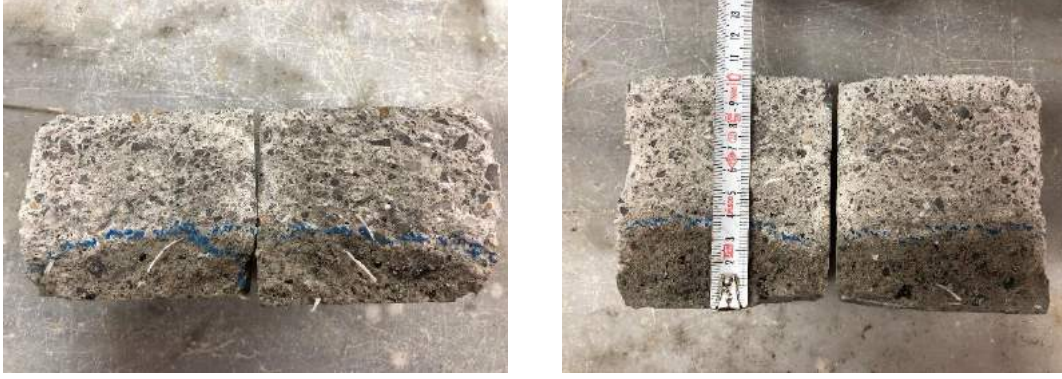
Şekil 7. İmpermeabilite testi sonucunda su işleme derinliğinin belirlenmesi
