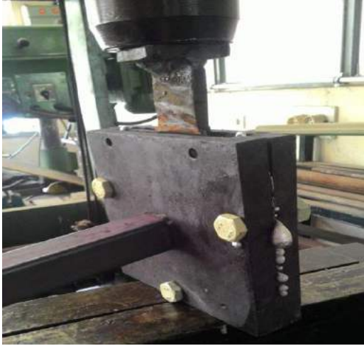
Şekil 0. Sıkıştırma yöntemi sonrası kalıp dışına çıkan sıvı malzeme ve sıkıştırma yönteminin görünümü
