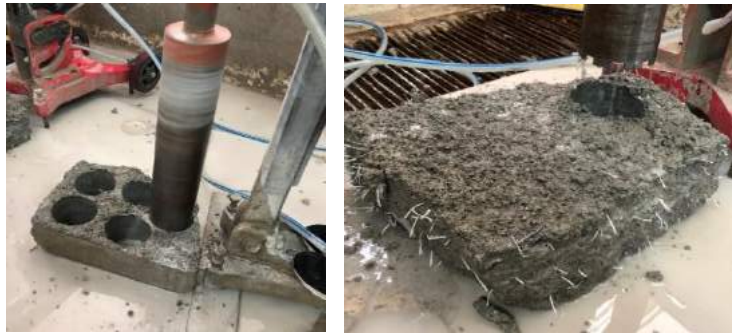
Şekil 3. Plak şeklindeki püskürtme beton örneklerden karot örneklerin alınması
