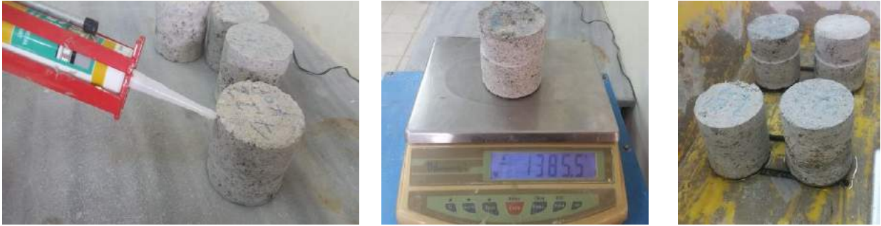
Şekil 3. Kapilerite test düzeneği
