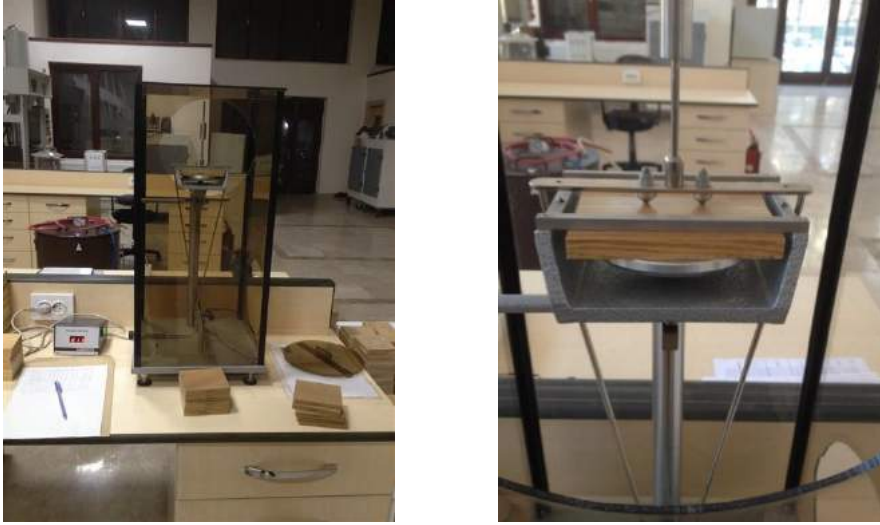
Fotoğraf 1. Pandüllü sertlik ölçüm cihazı (Erichsen).
