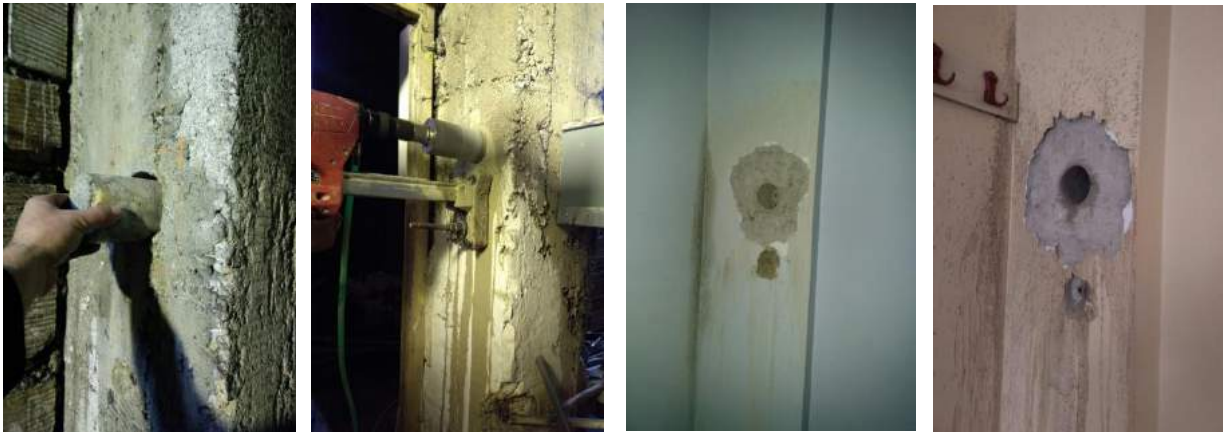
Şekil 7. Beton karot numunesi alınması
