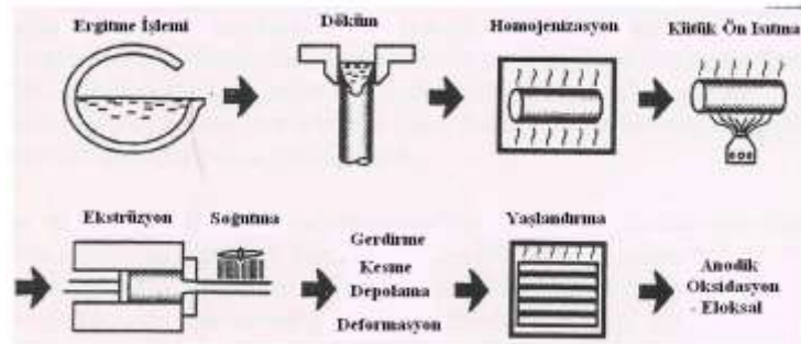
Şekil 1. Tipik bir ekstrüzyon fabrikasında üretim süreçleri [5]
